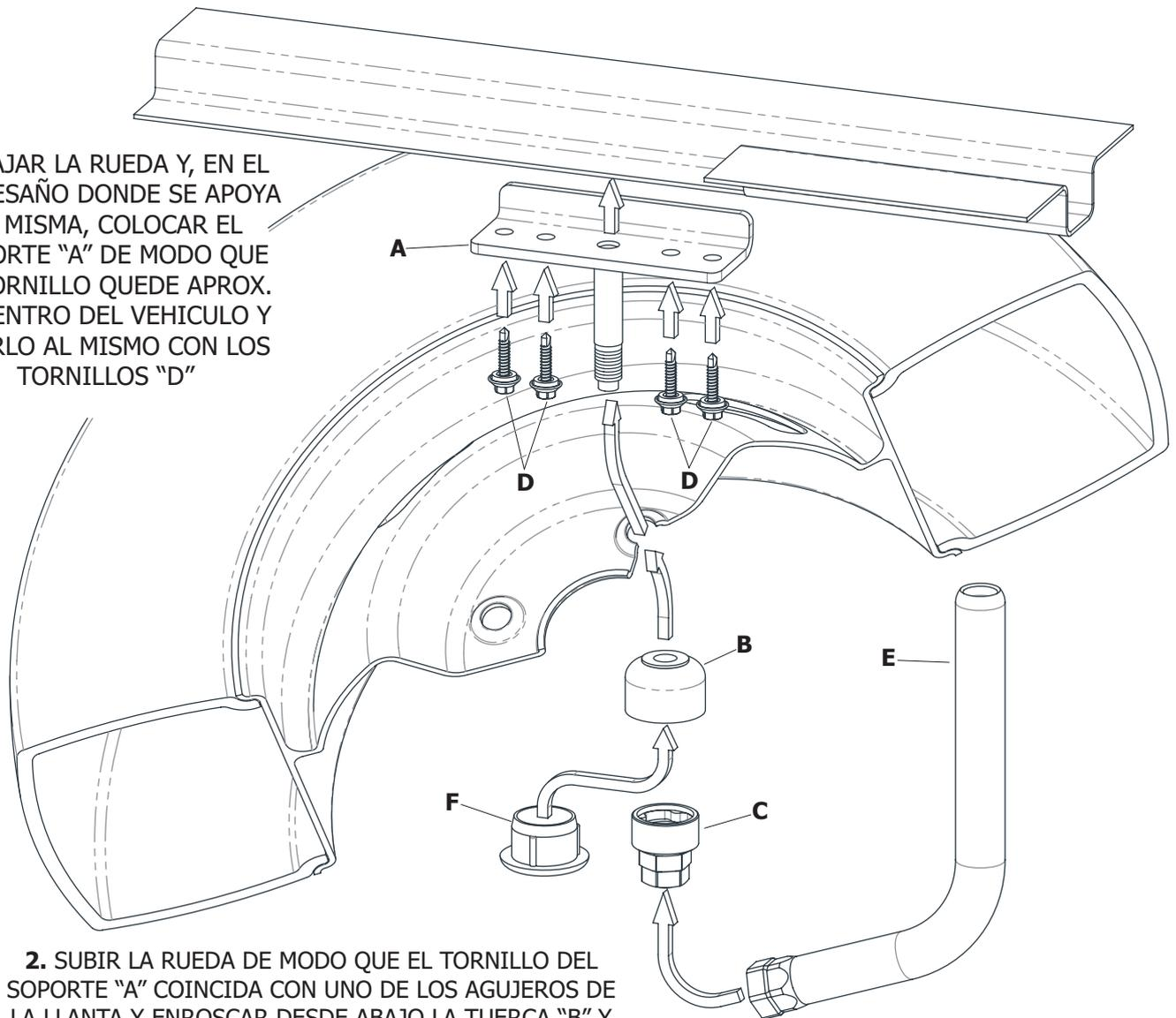
**2. SUBIR LA RUEDA DE MODO QUE EL TORNILLO DEL SOPORTE "A" COINCIDA CON UNO DE LOS AGUJEROS DE LA LLANTA Y ENROSCAR DESDE ABAJO LA TUERCA "B" Y AJUSTARLA CON LA LLAVE DE SEGURIDAD "C", UTILIZANDO EL TUBO LLAVE "E". LUEGO COLOCAR EL TAPÓN "F" EN LA TUERCA**
