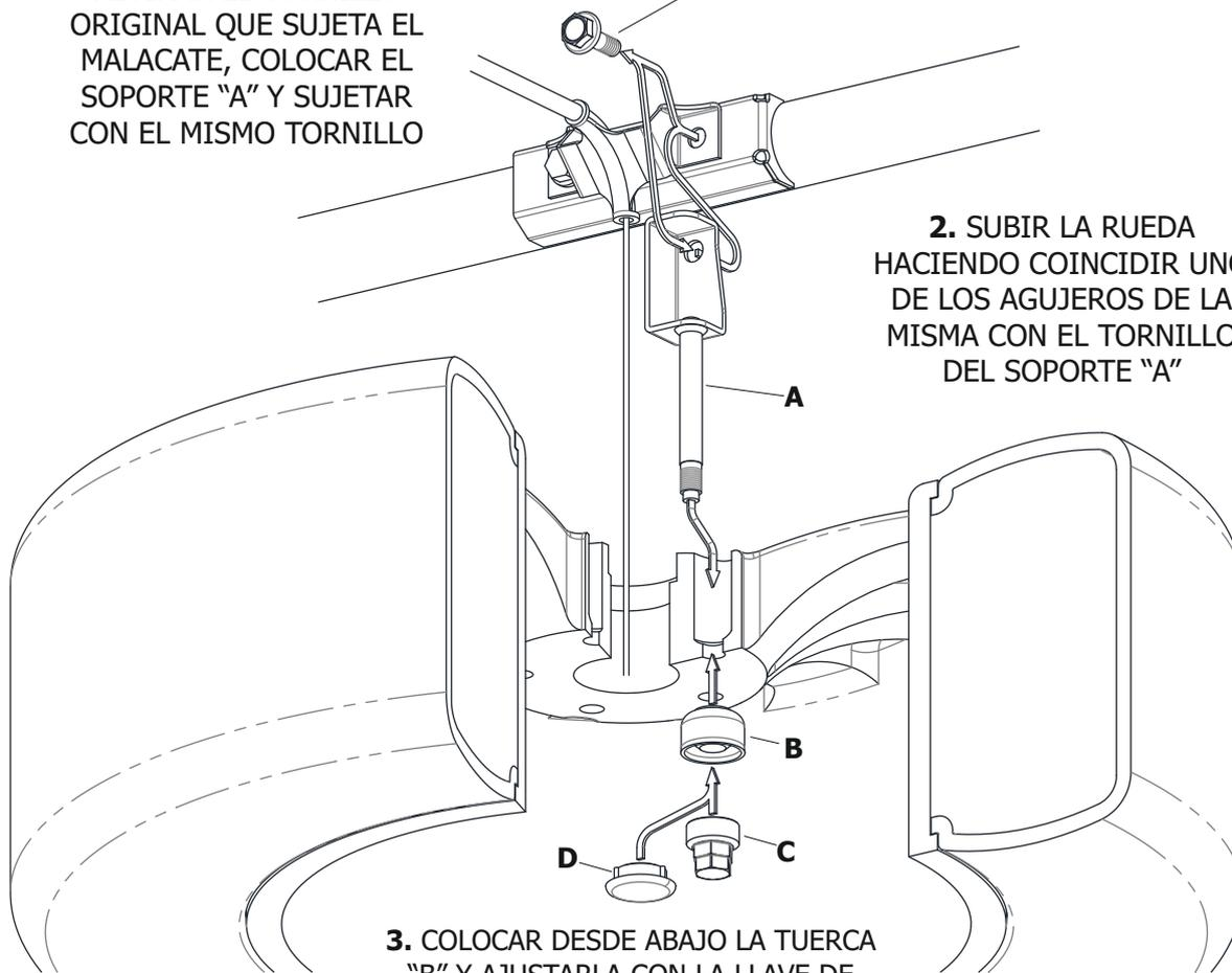
**3. COLOCAR DESDE ABAJO LA TUERCA "B" Y AJUSTARLA CON LA LLAVE DE SEGURIDAD "C". LUEGO COLOCAR EL TAPÓN "D" EN LA TUERCA**
