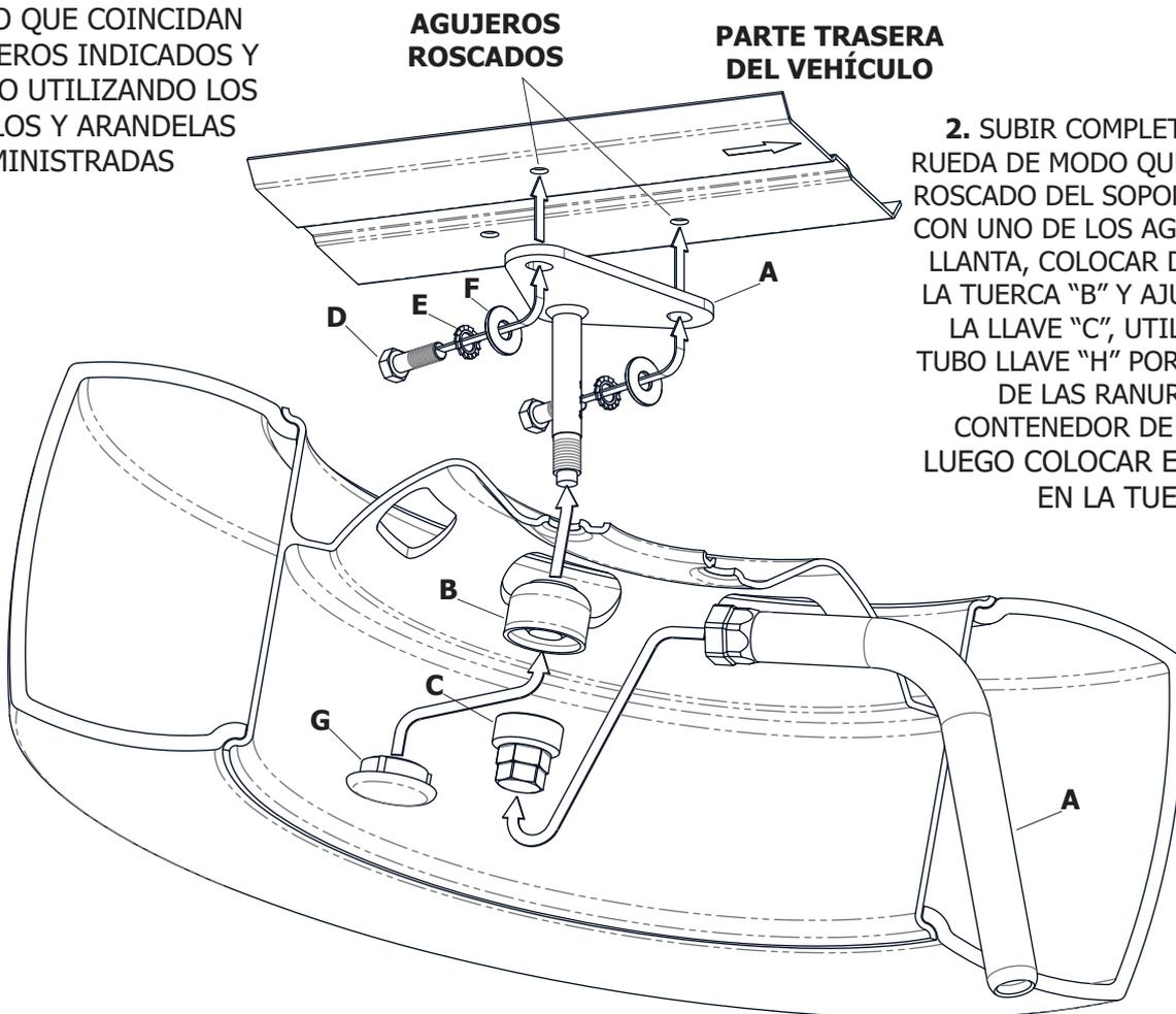
**2. SUBIR COMPLETAMENTE LA RUEDA DE MODO QUE EL EXTREMO ROSCADO DEL SOPORTE COINCIDA CON UNO DE LOS AGUJEROS DE LA LLANTA, COLOCAR DESDE ABAJO LA TUERCA "B" Y AJUSTARLO CON LA LLAVE "C", UTILIZANDO EL TUBO LLAVE "H" POR INTERMEDIO DE LAS RANURAS DEL CONTENEDOR DE LA RUEDA, LUEGO COLOCAR EL TAPÓN "G" EN LA TUERCA**
