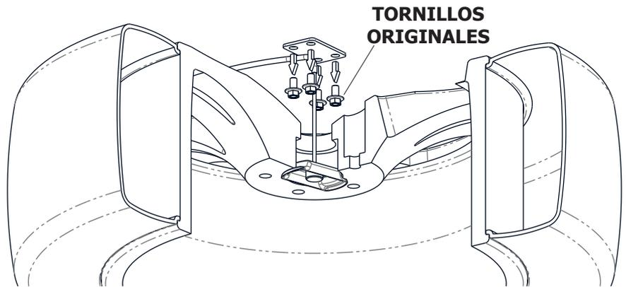
**2. COLOCAR EL SOPORTE "A" DE MODO QUE EL TORNILLO QUEDE HACIA LA PARTE DELANTERA DEL VEHÍCULO Y LOS AGUJEROS COINCIDAN CON LOS AGUJEROS DEL VEHÍCULO Y SUJETAR JUNTO CON EL MALACATE CON LOS TORNILLOS "F" Y LAS ARANDELAS "E" Y "D"**
