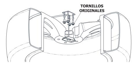
2. COLOCAR EL SOPORTE "A" DE MODO QUE EL TORNILLO QUEDE HACIA LA PARTE DELANTERA DEL VEHÍCULO Y LOS AGUJEROS COINCIDAN CON LOS AGUJEROS DEL VEHÍCULO Y SUJETAR JUNTO CON EL MALACATE CON LOS TORNILLOS "F" Y LAS ARANDELAS "E" Y "D"
