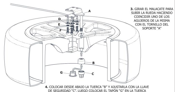
PRECAUCIÓN: GUARDAR LA LLAVE DE SEGURIDAD EN EL BOLSO PORTAHERRAMIENTAS Y, EN CASO DE PÉRDIDA, SOLICITAR UNA NUEVA MEDIANTE EL CÓDIGO IMPRESO EN LA TARJETA
