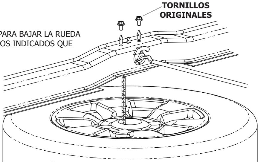
**2. COLOCAR EL SOPORTE "A" DE MODO QUE EL TORNILLO QUEDE HACIA LA PARTE DELANTERA DEL VEHÍCULO Y LOS AGUJEROS COINCIDAN CON LOS AGUJEROS DEL TRAVESAÑO Y SUJETAR JUNTO CON EL MALACATE CON LOS TORNILLOS "E" Y LAS ARANDELAS "F"**
