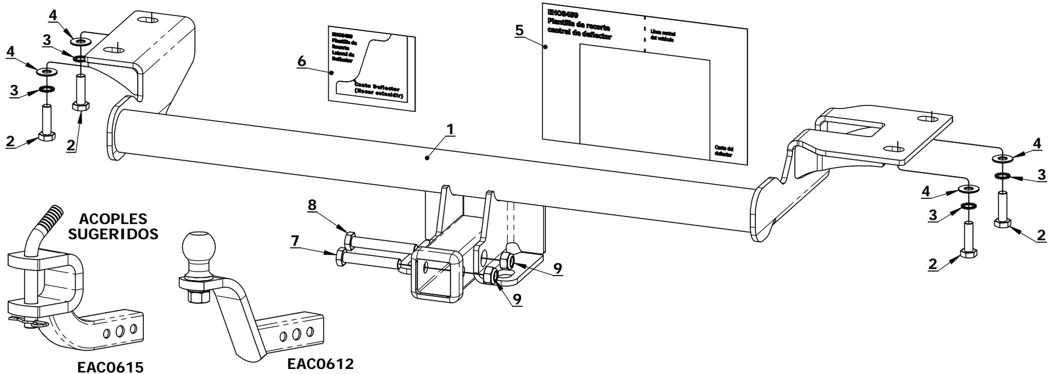
1. Retirar el deflector plástico y recortar en la parte central y en el lateral lado acompañante utilizando las plantillas suministradas
