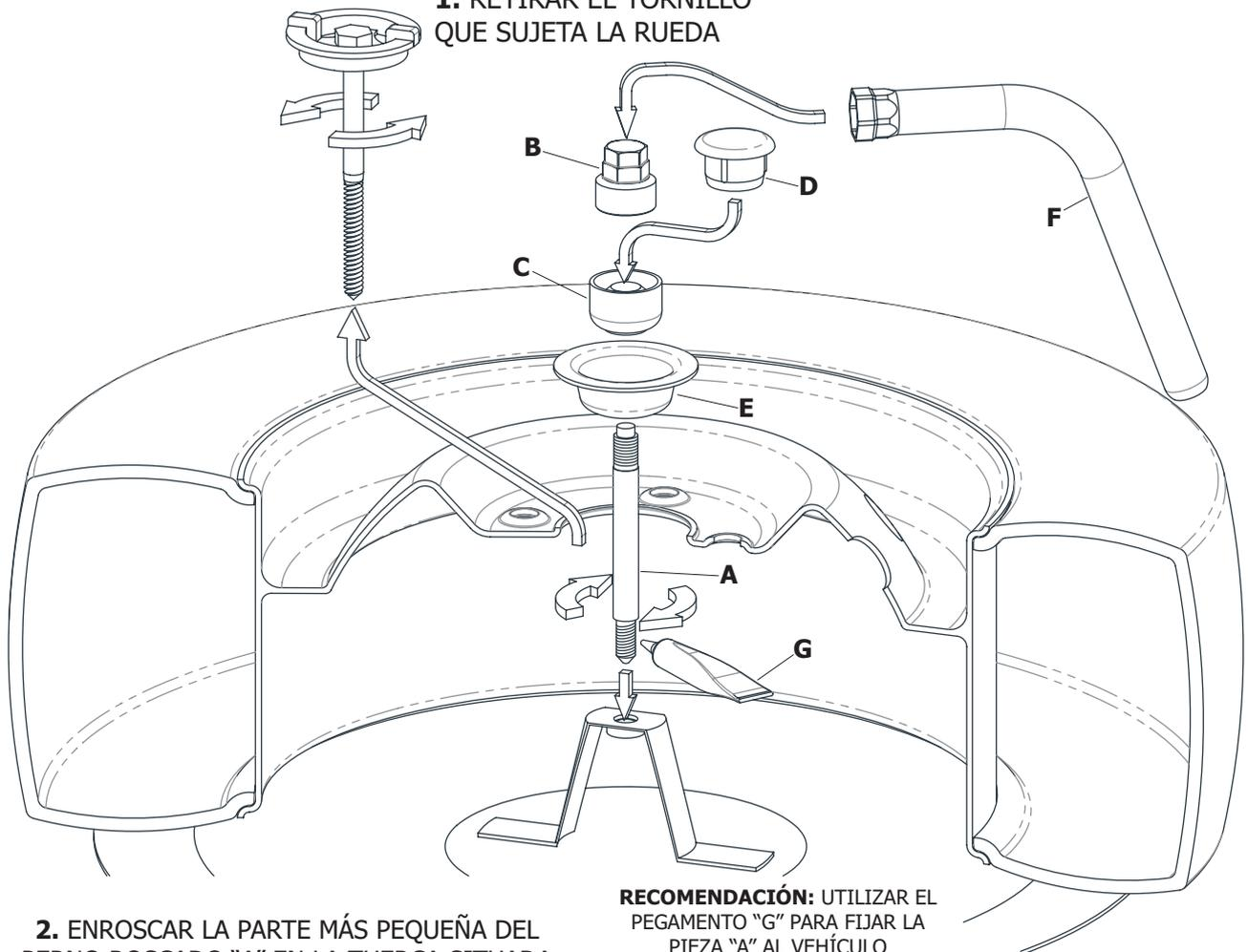
**2. ENROSCAR LA PARTE MÁS PEQUEÑA DEL PERNO ROSCADO "A" EN LA TUERCA SITUADA EN EL BAÚL, COLOCAR EL PLATO UNIVERSAL "E", LA TUERCA "C" Y AJUSTARLO CON LA LLAVE "B", UTILIZANDO EL TUBO LLAVE "F". LUEGO COLOCAR EL TAPÓN "D" EN LA TUERCA**
