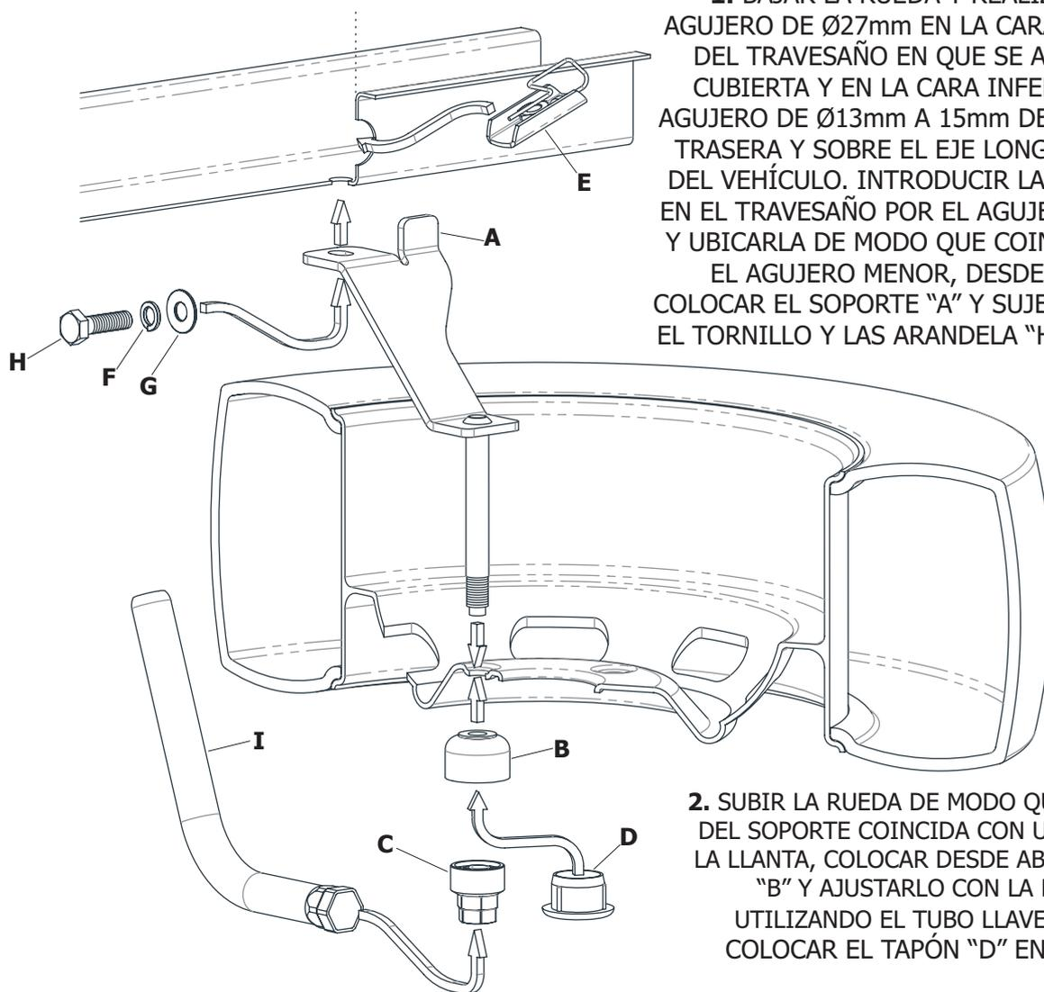
**1. BAJAR LA RUEDA Y REALIZAR UN AGUJERO DE Ø27mm EN LA CARA TRASERA DEL TRAVESAÑO EN QUE SE APOYA LA CUBIERTA Y EN LA CARA INFERIOR UN AGUJERO DE Ø13mm A 15mm DE LA ARISTA TRASERA Y SOBRE EL EJE LONGITUDINAL DEL VEHÍCULO. INTRODUCIR LA PLACA "E" EN EL TRAVESAÑO POR EL AGUJERO MAYOR Y UBICARLA DE MODO QUE COINCIDA CON EL AGUJERO MENOR, DESDE ABAJO COLOCAR EL SOPORTE "A" Y SUJETARLO CON EL TORNILLO Y LAS ARANDELA "H", "G" Y "F"**
